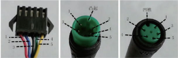
Terminal de conexión Controlador
